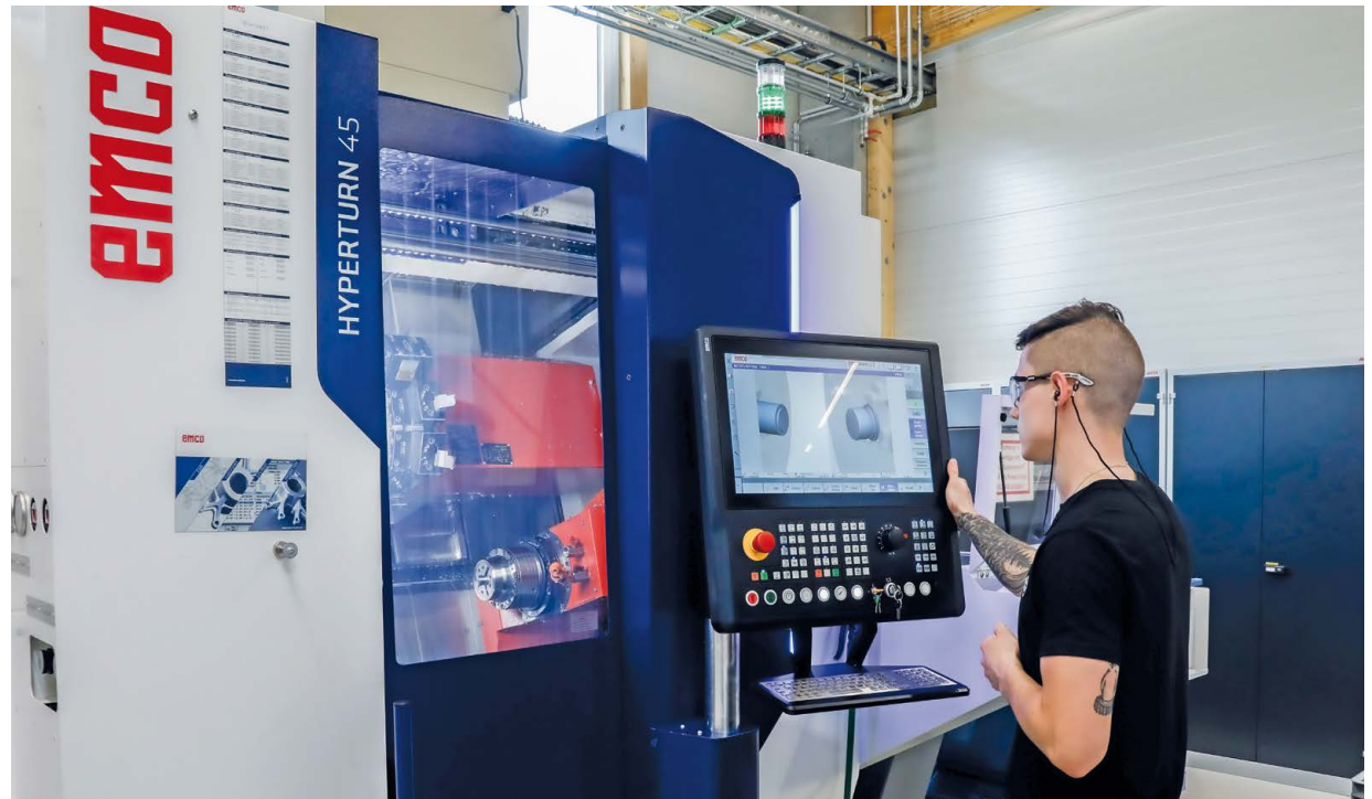
Die HYPERTURN 45 G3 überzeugt laut MSG durch eine sehr kompakte Bauweise, leistungsstarke Haupt- und Gegenspindeln, hochdynamische Antriebe in allen Achsen sowie zwei Werkzeugrevolver BMT45P mit angetriebenen Werkzeugen.
