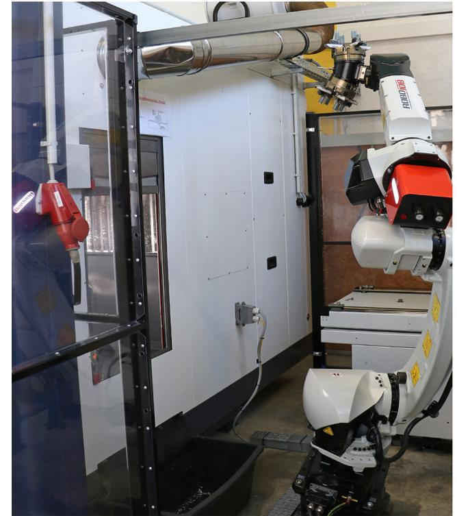
Die mit der Emco Maxxmill 750 verheiratete robotergestützte Tower-Lösung von RoboJob ermöglicht es, rund um die Uhr Bauteile zu bearbeiten.
