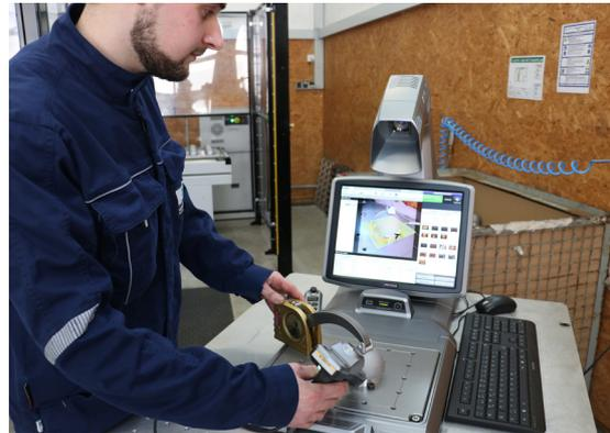
Mit stichprobenartiger Qualitätsprüfung weist Friedrich die geforderte Genauigkeit nach. Dank hochstefem Maschinen-aufbau erreicht die Emco Maxxmill 750 im praktischen Betrieb zuverlässig eine hohe Präzision im Hundertstel Millimeterbereich und Oberflächengüten von Rz = 1 µm.
