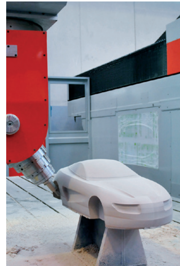
5-Achs-Bearbeitung des Querschnittes eines Automodells für das Styling-Zentrum
