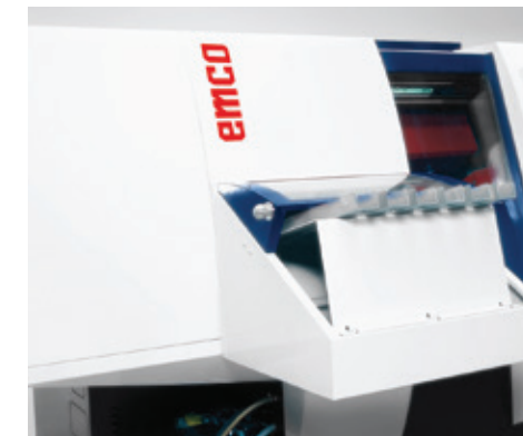
Mehrbahnige Zuführrinne für rotationssymmetrische Rohteile. Ein Sensor überwacht für jede Zuführrinne die Verfügbarkeit der Rohteile.
