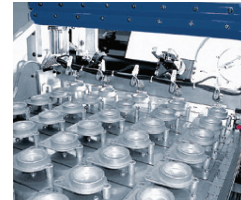
Taktförderband für die orientierte Rohteilzuführung mit großem Teilevorlauf.
