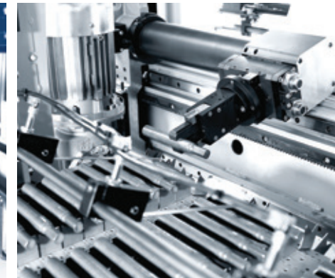
Taktförderband mit Prismenauflagen für unterschiedlich vorgeformte Wellenteile.
