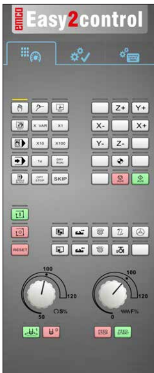
Panneau de commande de la machine
