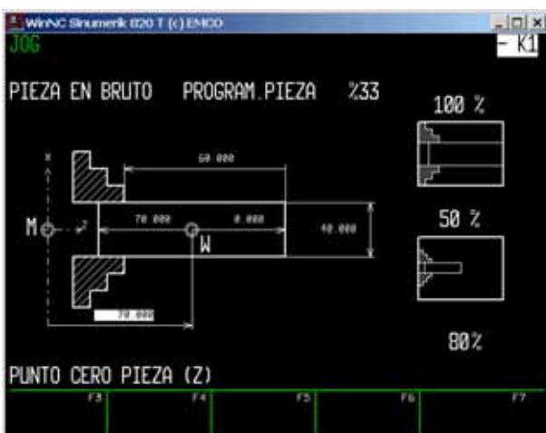
Definición de la pieza bruta SINUMERIK 810/820 T
