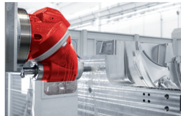
Lavorazione di uno stampo a iniezione per paraurti auto
