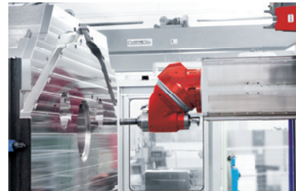
Lavorazione meccanica di uno stampo da parte di una testa universale 6000 giri/min.
