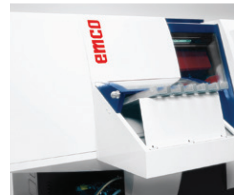
Nastro trasportatore multiplo per caricamento di grezzi tondi. Un sensore monitora la disponibilità di grezzi per ciascun nastro.
