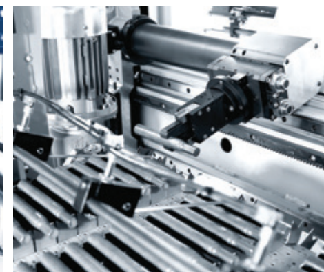
Nastro trasportatore con supporti a V per alberi preformati di varie forme.
