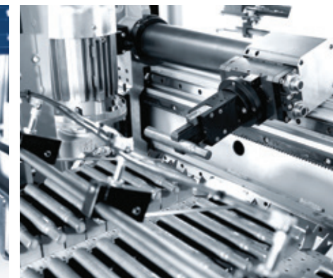
Łańcuchowy system podawania z podporami V dla wstępnie uformowanych wałków o różnych kształtach.
