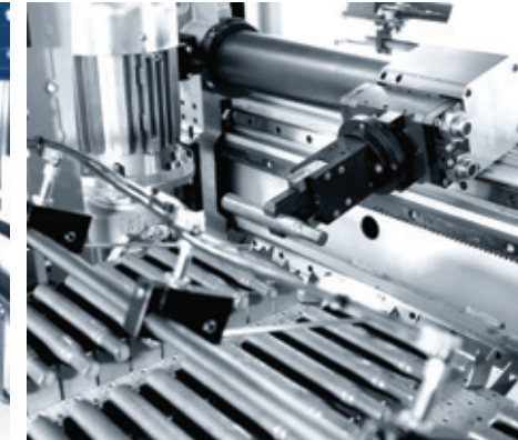
Taktförderband mit Prismenauflagen für unterschiedlich vorgeformte Wellenteile.
