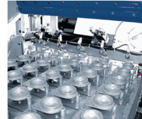
Taktförderband für die orientierte Rohteilzuführung mit großem Teilevorlauf.
