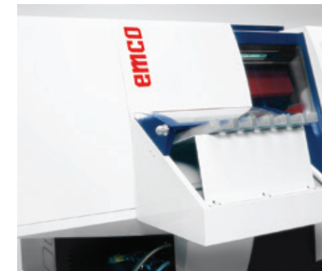
Mehrbahnige Zuführrinne für rotationssymmetrische Rohteile. Ein Sensor überwacht für jede Zuführrinne die Verfügbarkeit der Rohteile.
